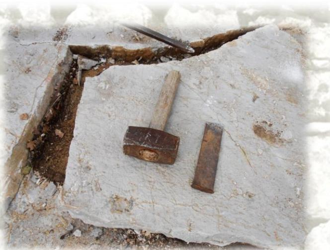
Osnovni alat za vađenje i obradu kamena:
